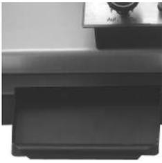
23. Der Abdampf wird in den Kamin geleitet, das entstehende Kondensat läuft in den Kondenswasserbehälter unter der Grundplatte. Dieser Behälter muss nach Beendigung des Dampfbetriebes entleert werden. Hierfür den Kondenswasserbehälter herausziehen und entleeren (siehe Abbildung links).
