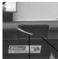
Zum Leeren des Speisewasserbeckens die Ablassschraube abschrauben und das Wasser in einem Behälter auffangen. Anschließend die Ablassschraube mit der Dichtung wieder aufschrauben (siehe Abbildung links).
