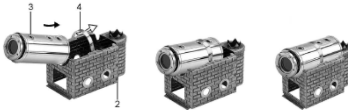
Afb. 2.2.1: montage van de ketel
