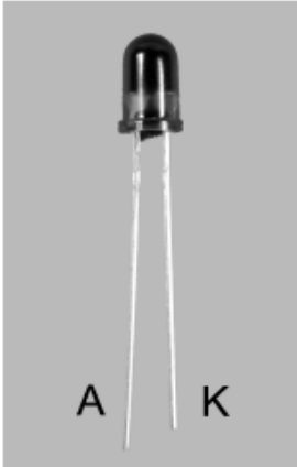
Afb. 3.09: aansluitingen van een led. De anode (+) heeft een langere aansluitdraad dan de kathode (-) en bij de kathode heeft de behuizing tevens een platte kant
