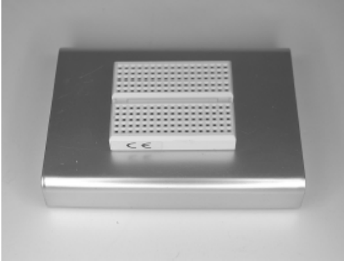
Afb. 3.07: Steekbord op een onderplaat geplakt. (onderplaat niet meegeleverd)
