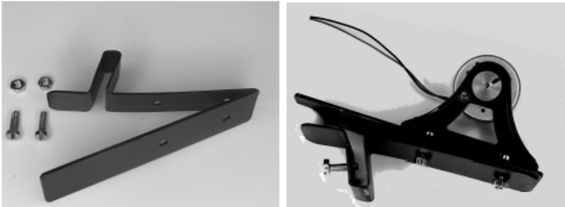
Afb. 3.26: Aanbouwonderdelen voor generatormontage, a) tweedelige generatorarm, b) lagerblok en stelschroef
