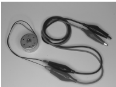
Afb. 3.20: a) Verbinding van generatordraad en krokodillenklem b) Detail, hoe de draad wordt ingeklemd voor een goed contact.
