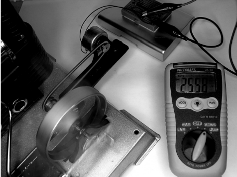
Afb. 3.29: meten van de generatorspanning met een multimeter, meetopstelling.
